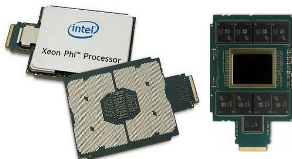
Figura 10. Processador Xeon Phi codinome Knights Landing para socket LGA 3647 e ele sem o dissipador de alumínio.
