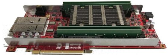
Figura 14. Placa utilizada em servidores da Microsoft com a FPGA Intel Stratix 10 [Freund, 2017].
